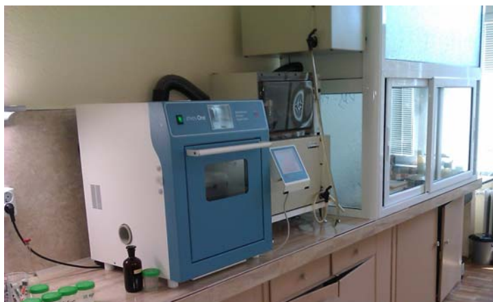
Фиг. 3. Лаборатория за пробоподготовка, MW система за разлагане на проби Milestone Ethos One
