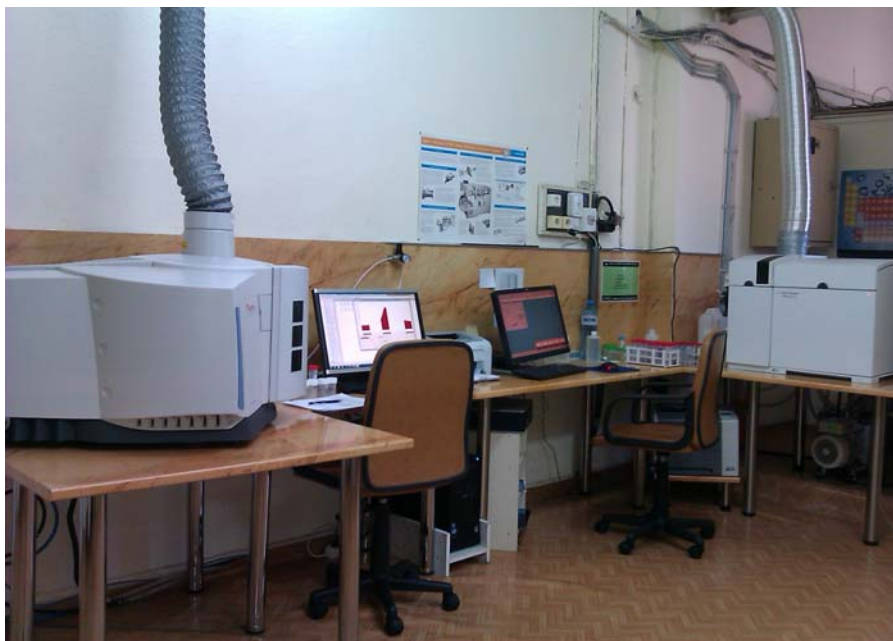
Фиг. 2 Двата нови апарата – в ляво ICP-OES спектрометър iCAP 6300 Thermo Scientific - BioSupport, в дясно ICP-MS Agilent 7700 – GAMA
